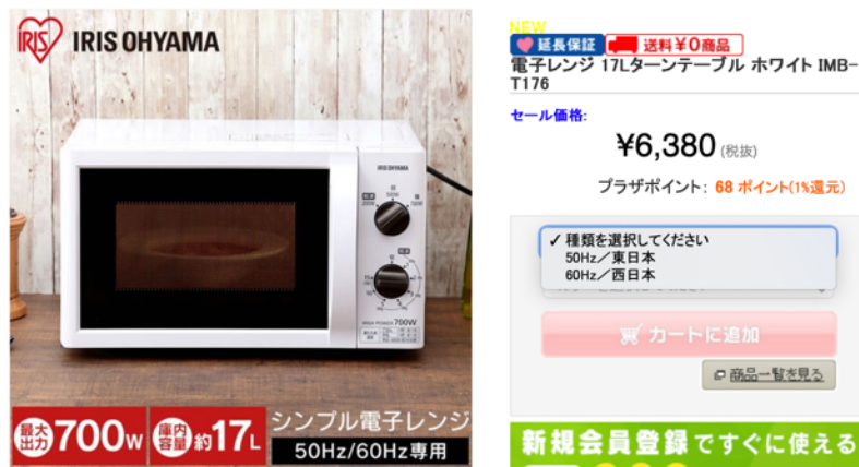
図 4-1 使用する電源周波数が決まっている電子レンジの例。購入時に使用周波数を選ぶ。 ( https://www.irisplaza.co.jp/index.php?KB=SHOSAI&SID=H509210F より)
