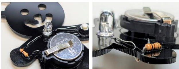
図 1：レーザー加工機で出力する場合の導線の固定方法
