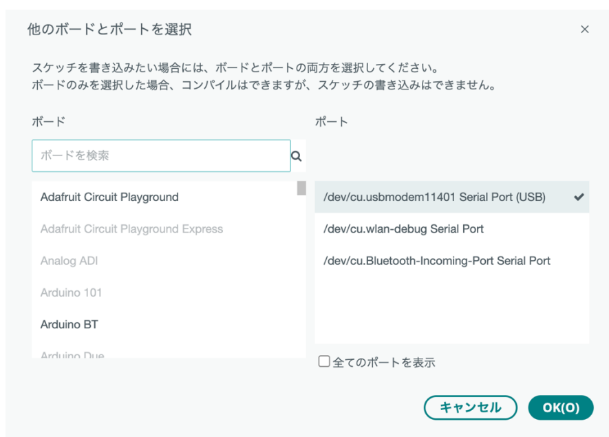
図 3-1 マイコンボードとシリアルポートの選択 (macOS 14.7, Arduino IDE 2.3.4)
