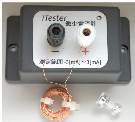
図 9 試作した微小電流計(測定範囲±3[mA], 分解能0.125[μA]).
