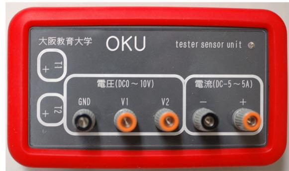
図 1 iTester センサユニットの外観。左側面に USB 端子と K 型熱電対の端子があり、上面に電圧と電流測定用の端子がある。
