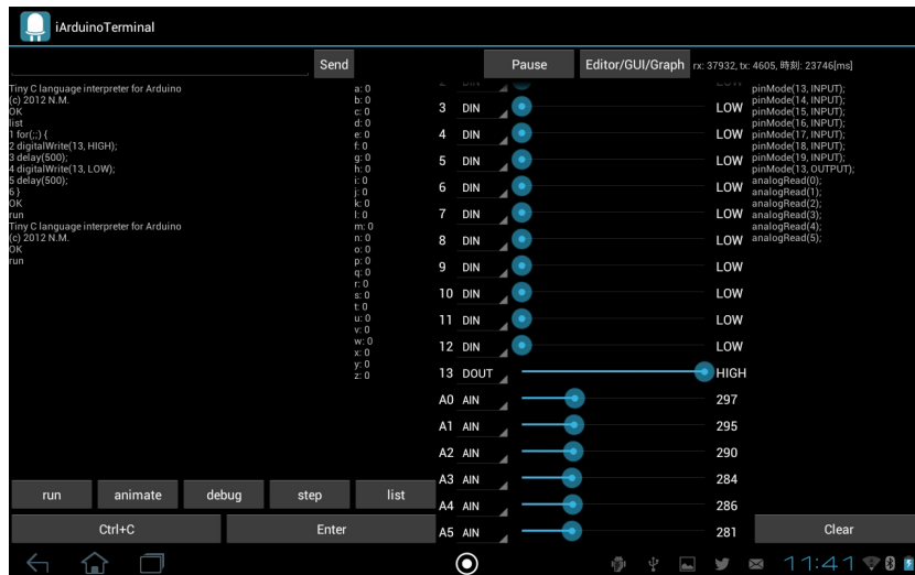
図 2 iArduinoTerminal for Android の起動時の画面。左半面にシリアルターミナルと変数の値表示があり、右半面で Arduino の各ピンのモードと値を表示・操作できる。
